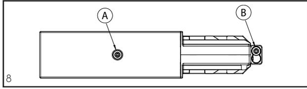
**IT** - Viti della testata **EN** - End-feed screws **FR** - Vis de raccord électrique
