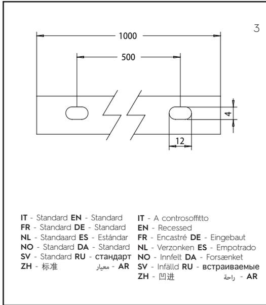
**IT** - Posizione asole e fissaggio con vite
