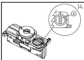
**IT** - Selettore di fase **EN** - Phase selector **FR** - Sélecteur de phase **DE** - Wahlschalter Phase **NL** - Fase selector **ES** - Selector de fase **NO** - Fasevelger **DA** - Valg af fase **SV** - Fasväljare **RU** - Селектор фазы **ZH** - 相位选择器
