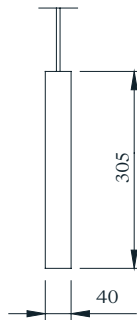
FineLine TubeLED Micro Pendant 040-PM-FLS 7.4W / 478 lm 15°, 24°, 38°
