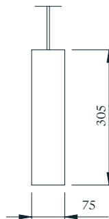
FineLine TubeLED Midi Pendant 075-PM-FLS 22W / 1185 lm 12°, 19°, 34°
